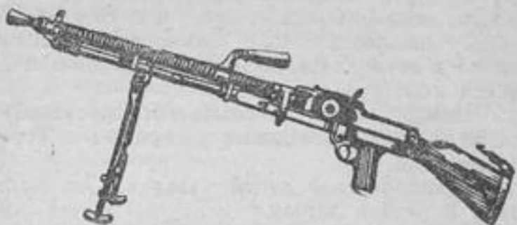
Рис. 105. Ручной пулемет ZB-30 (ZB-26.)
