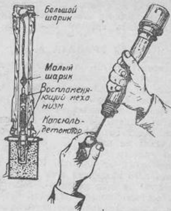
Рис. 111. Ручная граната М-24.
