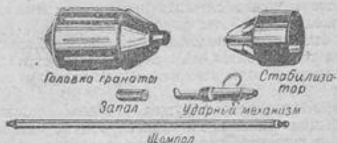
Рис. 76. Винтовочная противотанковая граната. Здесь изображены отдельные части гранаты. На стр. 161 показана граната в собранном виде и подготовка ее к бою.
