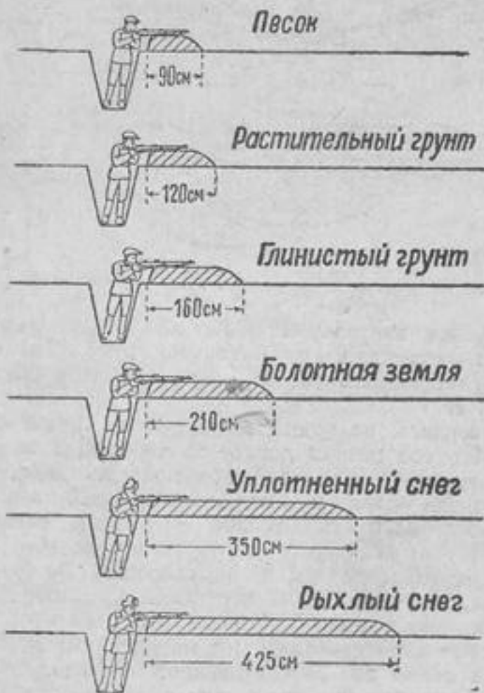
Рис. 87. Какой толщины должен быть бруствер из различных грунтов.
