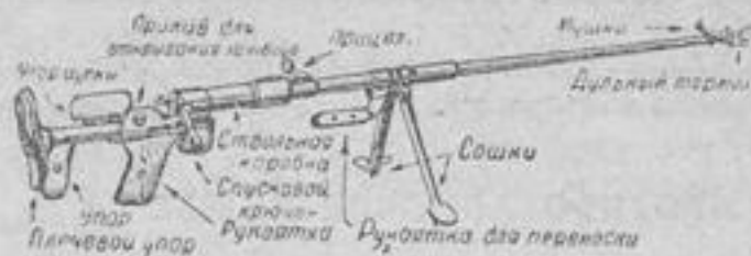
Рис. 74. Противотанковое ружье Дегтярева.
