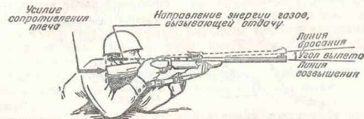
Рис. 47. Образование угла вылета
