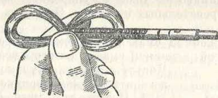
Рис. 159. Накладывание пакли на протирку
