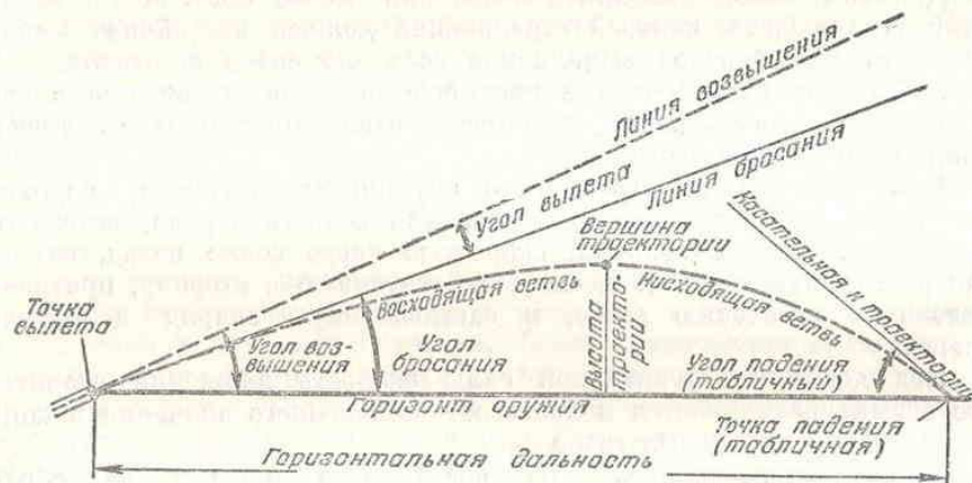
Рис. 49. Элементы траектории полета пули относительно горизонта оружия
