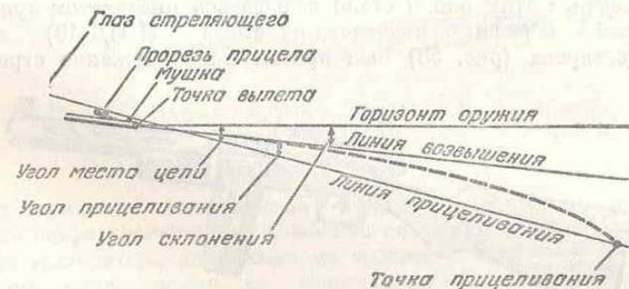
Рис. 52. Элементы траектории при стрельбе с большими отрицательными углами места цели
