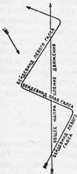
Рис. 38. Схема лавирования на парусной шлюпке.
