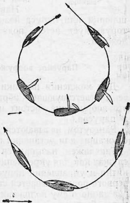
Рис. 39. Последовательные положения при поворотах оверштаг и фордевинд.
