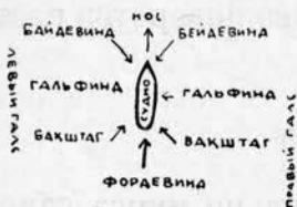
Рис. 40. Направление ветра относительно курса шлюпки.
